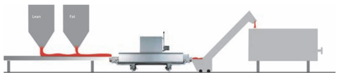
Fleisch zur Weiterverarbeitung Der MeatMaster™ ist integriert zwischen Fleischwolf und Mischer.
