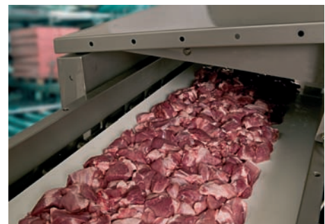
Das Fleisch kann in Boxen, Kisten oder lose auf dem Förderband gemessen werden.
