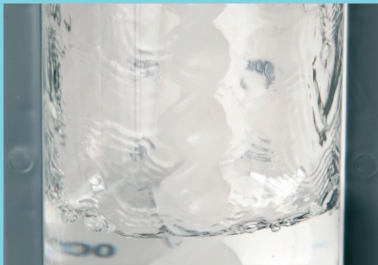
Titrationgefäß mit automatischer Spülvorrichtung
